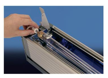
Ein speziell entwickelter UV-Strahler emittiert vorwiegend UV-Strahlung im Spektralbereich oberhalb von 380 nm, also genau dort wo die Photoinitiatoren absorbieren und die Pigmente nicht. Ein besonders optimierter Reflektor reflektiert sehr intensiv genau diesen Spektralbereich, der jetzt tief in die Farbschicht eindringen kann. Erst durch diese Kombination werden die entsprechenden Vorteile voll wirksam.
